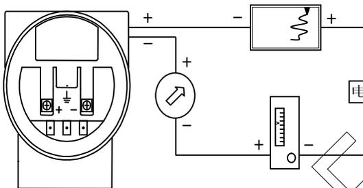
图 6 CY3058 物位变送器接线图
